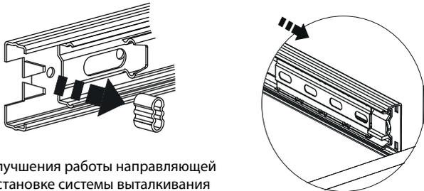
Для улучшения работы направляющей при установке системы выталкивания извлечь резиновый ограничитель хода с направляющей.
